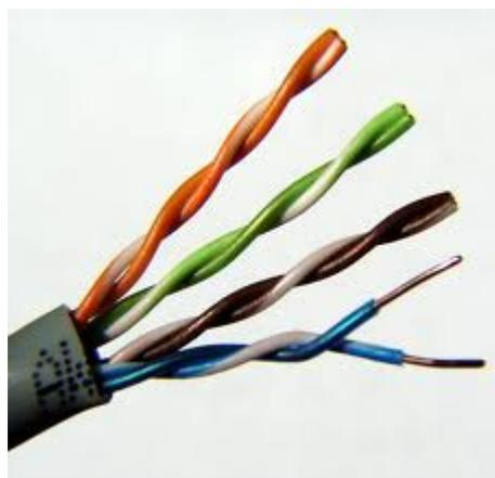
Gambar 9. Kabel UTP
